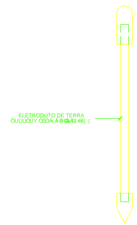
CONECTOR DE COBRE PARA HASTE 5/8" OU 3/4" TIPO "CHCV"
