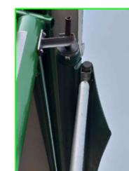
Imagem ilustrativa Eixo fixador da lona para cobertura
