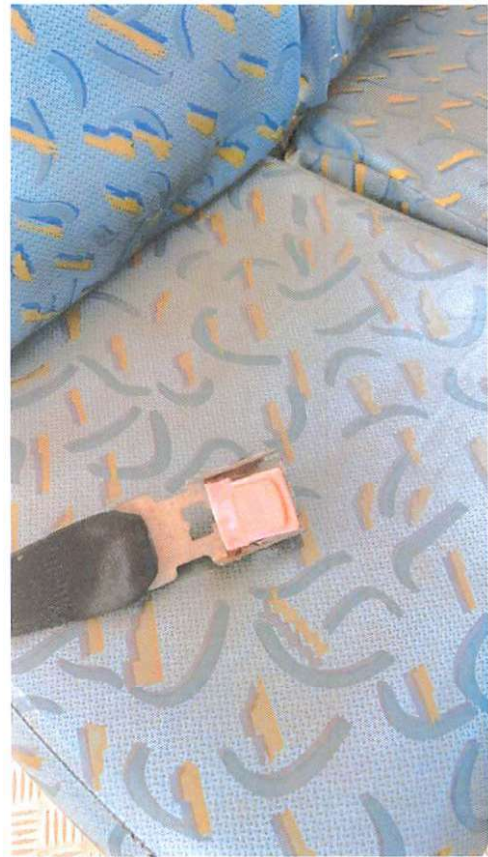
Imagem 2 – Cinto de segurança quebrado
