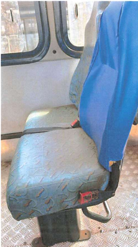
Imagem 1 – Cinto de segurança quebrado
