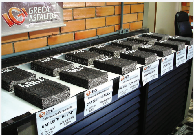
Figura 8: Placas após o ensaio de deformação.
