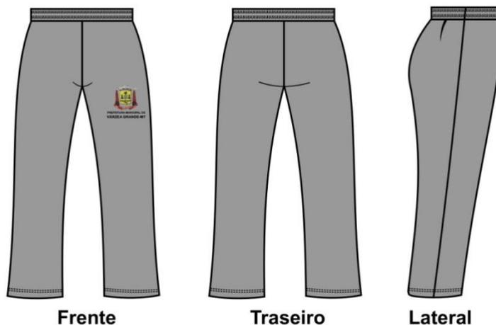
Calça confeccionada em helanca 100% poliamida, fio 6 ou 6.6 , gramatura 260g/m<sup>2</sup> tipo bailarina e cor cinza (Pantone 17-1506 TPX). Cintura da calça com elástico de 4 cm de largura pregado em máquina overloque e rebatido em máquina catraca 4 agulhas em ponto corrente. Barra da calça deve ser feita em máquina cobertura duas agulhas largas, com 2,0 cm de largura. Para confecção desta peça deve ser utilizada linha 100% poliéster, nº 120 na cor do tecido.
