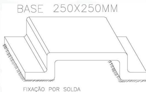
Figura 1 – Base de fixação de mastro.
