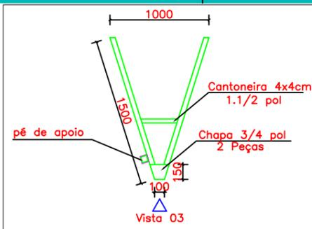
Planta Baixa: Detalhe da estrutura - Puxador
