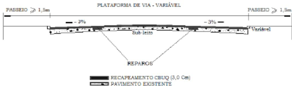
Figura 1.0 – Seção tipo de recapeamento com CBUQ
