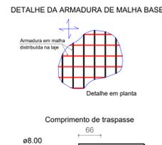
Armação inferior do radier do pavimento BALDRAME (Eixo X)
