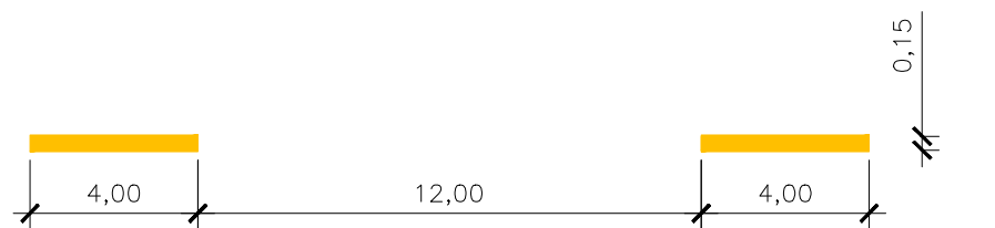
DETALHE "1" LINHA SECCIONADA 1:3 – AMARELA PLANTA SEM ESCALA
