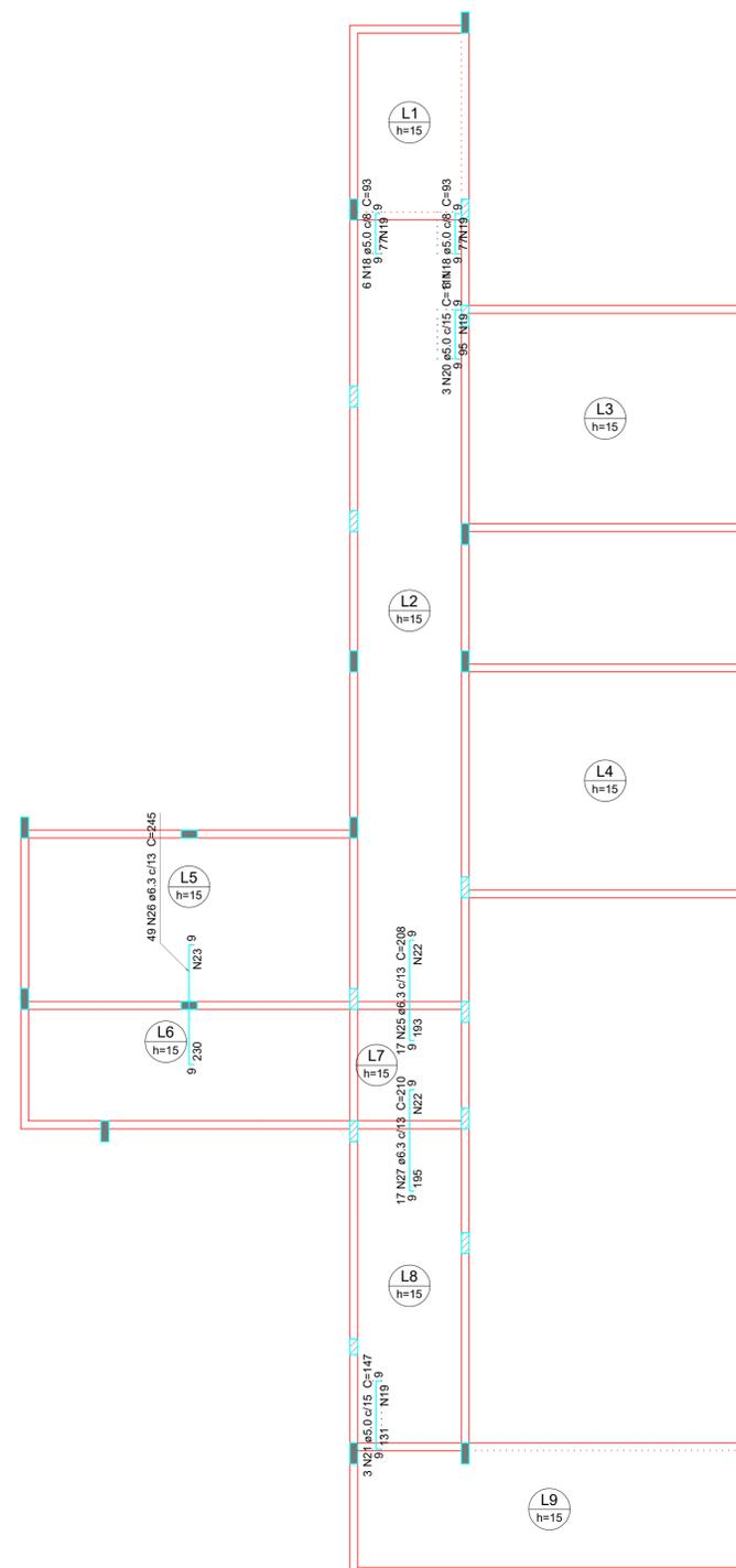
Armação negativa das lajes do pavimento CINTA (Eixo Y) escala 1:75
