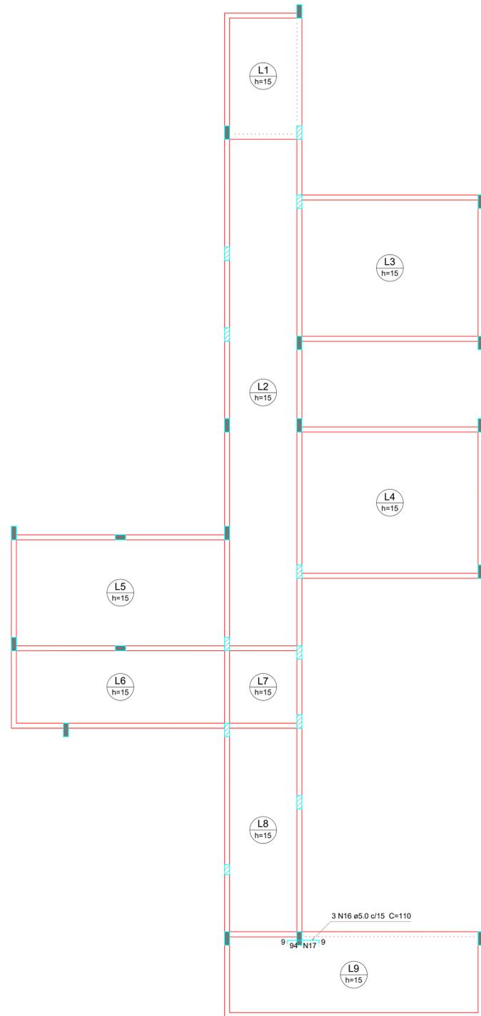
Armação negativa das lajes do pavimento CINTA (Eixo X) escala 1:75
